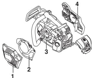
Производите очистку системы охлаждения щеткой раз в неделю или чаще, если этого требуют условия работы. Загрязненная или засоренная система охлаждения может привести к перегреву машины и вызвать повреждение поршня и цилиндра.
