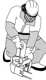
Как только заработает двигатель (это можно определить по характерному звуку), нажимайте кнопку пускового устройства. С силой вытягивайте шнур, пока не запустится двигатель. Когда двигатель запустится, дайте полный газ и отпустите рычаг дроссельной заслонки и блокировка пускового положения дроссельной заслонки отключится.
