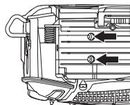
Глушитель служит для снижения уровня шума и отвода раскаленных выхлопных газов от рабочего. Выхлопные газы очень горячие и могут содержать искры, что может привести к пожару при прямом попадании на сухой и воспламеняющийся материал.
