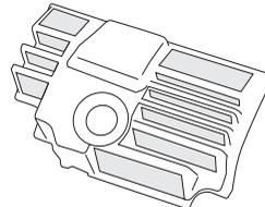
Моторная пила HUSQVARNA может быть оборудована воздушными фильтрами разных моделей в зависимости от погодных и рабочих условий, сезона и т.д. Обращайтесь за советом к Вашему дилеру.
