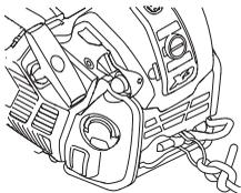
б) Используйте соответствующие карабины для непрямого (например, с помощью строп) и прямого (например, непосредственно в точке крепления) присоединения пилы к обвязке оператора.
