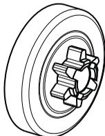
Следует регулярно проверять степень износа звездочки привода. Заменять при сильном износе. При замене цепи следует одновременно заменять и звездочку привода.
